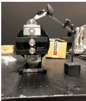
Figura 3. Nivelación de alturas
