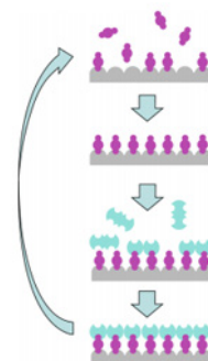
Figura 1. Representación del ciclo de deposición de ALD. Un precursor se expone alternativamente a precursores que experimentan reacciones auto limitantes en la superficie. La repetición del ciclo de depósito conduce al crecimiento capa por capa (Delezah, 2012).
