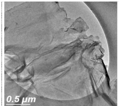
Figura 7. Imagen de microscopía de transmisión de una película de grafeno.
