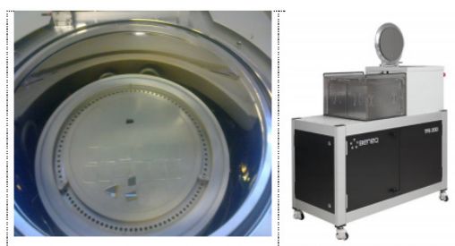
Figura 3. Imagen del reactor de ALD marca BENEQ.
