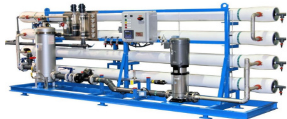
Figura 2. Bastidores de Ósmosis Inversa, con bombas de alta presión. Al centro tubos que contienen a los módulos de membranas. El sistema cuenta además con PLC de control automatizado.
